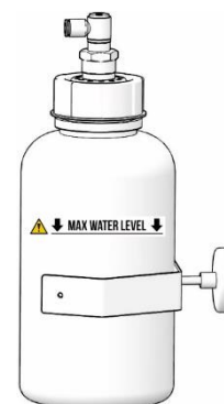
Рис. 10: Проверка резервуара для сбора конденсата
