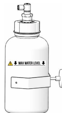
Rys. 10: Sprawdź poziom kondensatu w naczyniu
