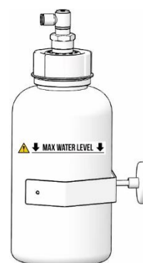
Fig. 10: Vérification de la cuve de collecte de condensats
