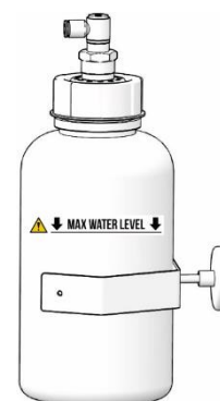
Obr. 16: Kontrola nádoby na zber kondenzátu
