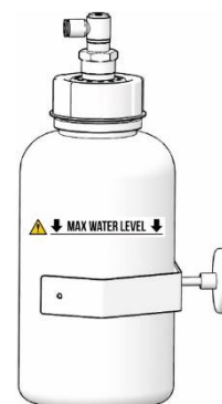
Рис. 16: Проверка резервуара для сбора конденсата
