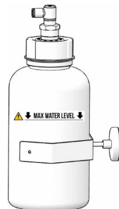
Abb. 18: Überprüfen des Kondensatauffangbehälter
