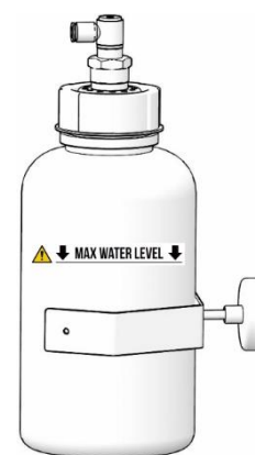
Рис. 18: Проверка резервуара для сбора конденсата
