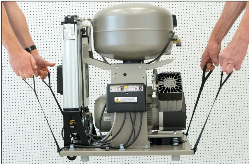
Abb. 4: Handhabung des Kompressors mittels Tragegurten
