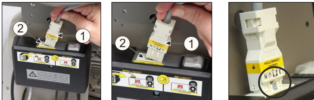
Рис. 11: Подключение шкафа к компрессору
