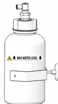
Rys. 18: Sprawdź poziom kondensatu w naczyniu
