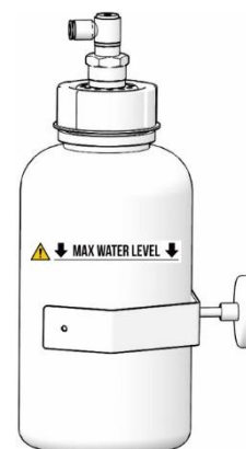
Obr. 18: Kontrola nádoby na zber kondenzátu
