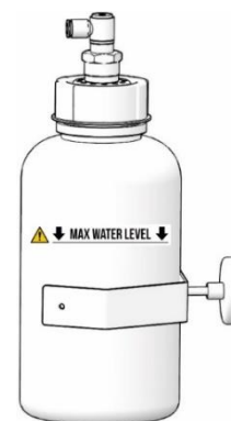
Obr. 18: Kontrola nádoby na kondenzát
