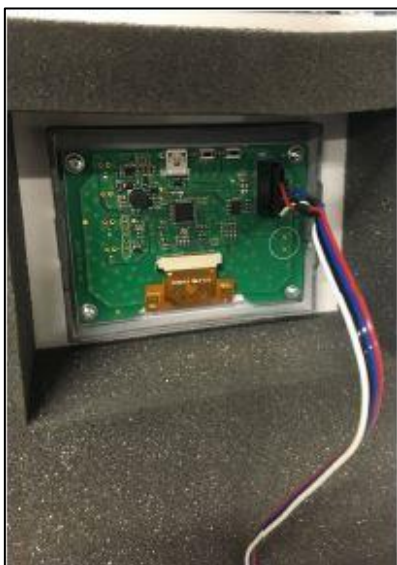
Rys. 15: Podłączenie złącza wyświetlacza
