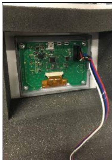
Rys. 17: Podłączenie złącza wyświetlacza
