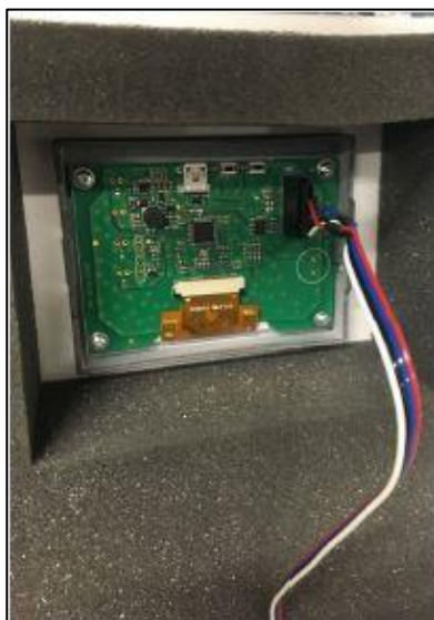
Abb. 17: Anschließen des Displaysteckers
