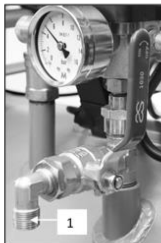
Рис. 8: Подключение к выпускному воздухопроводу сжатого воздуха
