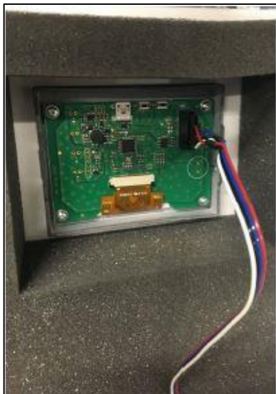
Fig. 17: Branchement du connecteur de l'écran
