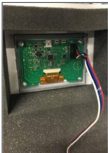
Рис. 17: Подключение разъема дисплея
