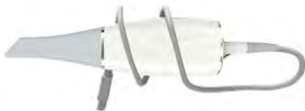
Obrázek 8 Nesprávné uložení kabelu skeneru
