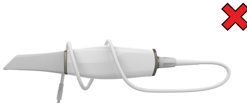
Obrázek 17 Nesprávné uložení kabelu skeneru IS 3800
