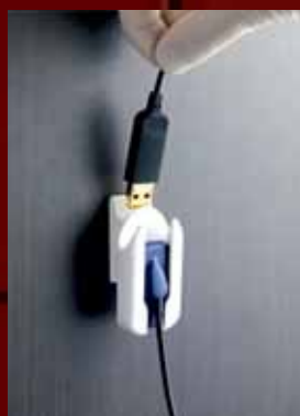
Držák na stěnu slouží k bezpečnému uložení snímačů a USB konektoru
